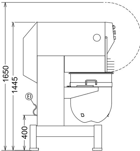
EI = Conexión eléctrica (energía)
